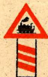
Baken VOR Bahnübergängen 240m
