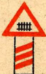
Baken VOR Bahnübergängen 240m
