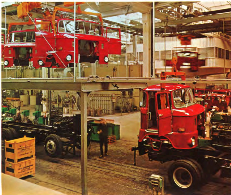
Teilsicht des Endmontagebandes des IFA W 50. Auf dem Bild ist die Koppelstelle zwischen Fahrerhaus und Fahrgestell festgehalten.
