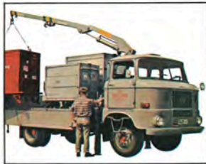
Nutzkraftwagen IFA W 50 L/L mit Ladekran LDK 1250. Max. Tragfähigkeit des Krans 1250 kp. Ein für den Transport von ISO-Containern und Paletten geeignetes Fahrzeug.
