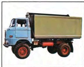
IFA W 50 LA/Z ND mit Schwerhackselaufbau SHA 16. Fassungsvermögen des Aufbaus 16 m 3 .
