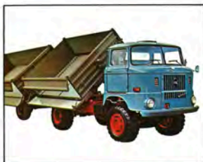
IFA W 50 LA/Z 2 SK 5 ND Grundtyp für die Landwirtschaft. Ladefläche 3050 x 2360 x 850 mm, Nutzlast 4550 kp, zulässige Anhängemasse 12 000 kp, automatische Bord- wandbetätigung.
