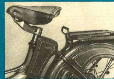
Großer, bequemer Schwingsattel mit neuem Sattelgestell. Der stabile Gepäckträger besitzt jetzt eine als Aufstellgriff ausgebildete Gepäckstütze und ein praktisches Gummispannband zur sicheren Haltung des Gepäcks.
