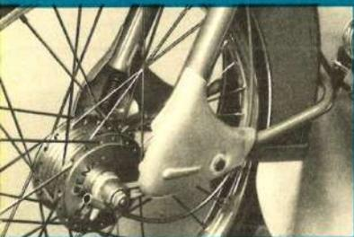
Neue elastische und leichtere Vordergabel in Schweißkonstruktion mit gleichzeitiger Vergrößerung des Radfederweges auf 72 mm.
