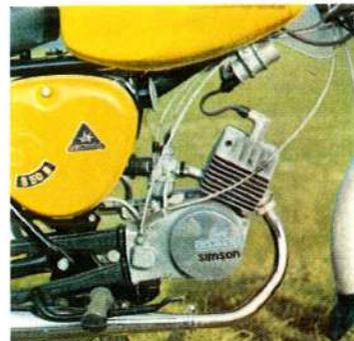
Das robuste fahrtwindgekühlte 3,6 PS -Triebwerk mit fußgeschaltetem 3-Ganggetriebe ermöglicht auch bei Sozusbetrieb eine Höchstgeschwindigkeit von 60 km/h.
