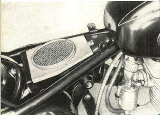
Unsichtbar ist der Luftfilter unter dem Sitzkissen des Fahrers angebracht. Der Motor erhält somit durch den schräg angeordneten Vergaser beruhigte Luft, was eine Leistungssteigerung begünstigt.
