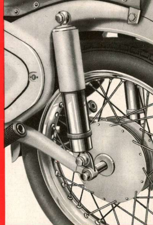
Beste Federung durch ölgedämpfte Federbeine in Verbindung mit der ...
