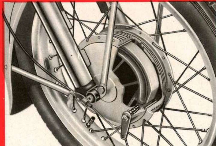
Höchste Fahrsicherheit durch geschmiedete überdimensionierte Leichtmetall-Vollnaben-Bremsen.
