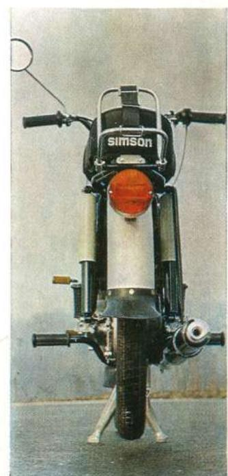
Neuen Bedürfnissen entsprechend wurde das neue Mokick S 50 N konzipiert. Das zweiseitige Kleinkraftfahrzeug erreicht bis 60 km/h. Der Motor arbeitet mit Fahrtwindkühlung und meistert auch Soziasfahrten bei Sommerhitze. Zylinder und Zylinderkopf besitzen eine größere Verrippung. Das Fahrzeug ist mit einem 3-Ganggetriebe ausgerüstet. Der Motor hängt elastisch im Rahmen, was die Motorschwingungen dämpft. Die wichtigsten Bauteile sind an dem Brückenrahmen angeschraubt und so leicht reparierbar.
