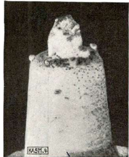
Bild 4 Durch Überhitzung zerstörter Kerzeneinsatz
