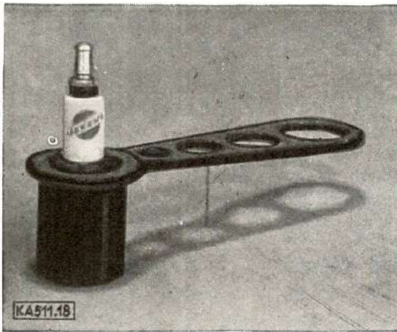
Bild 21 Ein zweckmäßiger Kerzenschlüssel
