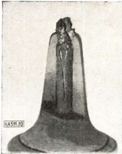
Bild 13 Durch Schwefeleinwirkung zerstörter Kerzeneinsatz
