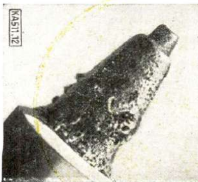
Bild 15 Teerartige Verbrennungsrückstände von schwersiedenden Bestandteilen des Kraftstoffes
