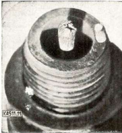
Bild 14 Durch Schwefeleinwirkung zerstörte Elektroden
