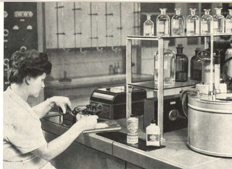
Alle Globo-Qualitätserzeugnisse verlassen das Werk erst dann, wenn sie harten Prüfbedingungen restlos entsprochen haben. Im Bild wird Globo-Lackbalsam und Globo-Polish einer elektropoptischen Glanzmessung auf Lackflächen unterzogen.
